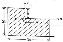
The position of the centre of mass of the uniform plate as shown in the figure is চিত্রে প্রদর্শিত সুষম পাতটির ভরকেন্দ্রের অবস্থান হল
